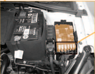
Sicherungsbox im Motorraum
